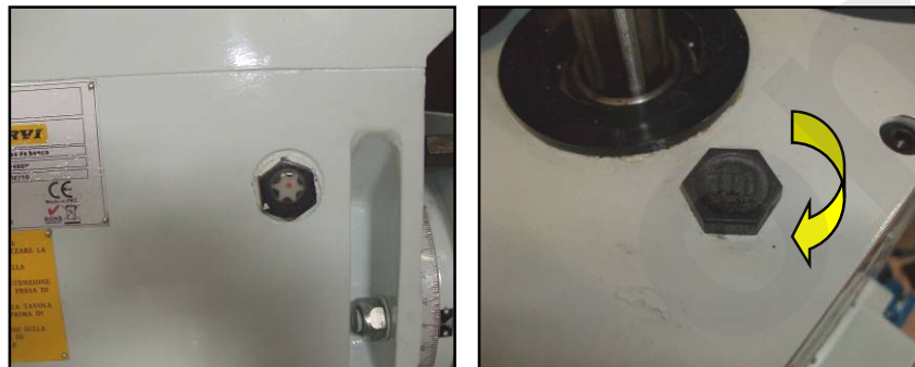
Figura 27 – Spia e tappo dell'olio lubrificante
